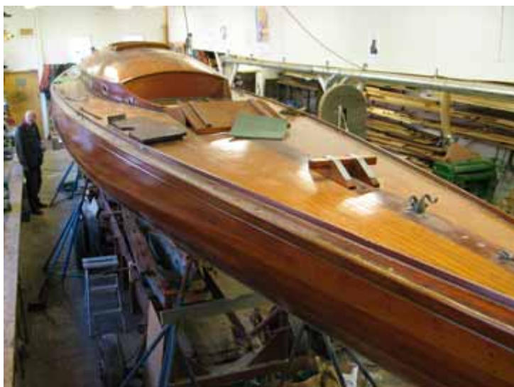
40 S20 Harriet i verkstaden för renovering. Längd: 13,51 och Bredd: 2,24. Konstruktör: Tore Holm, 1929. Foto: Dennis Wetterberg, Augusti 2008.
