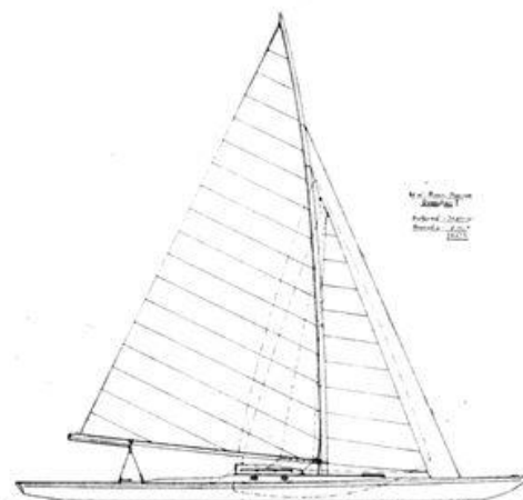
Segelriss des 40 qm-Rennkreuzers Wetterfest II. Maßstab 1:160. Grosssegel 30,871 qm, Vorsegel (Dreieck) 9,002 qm, zus. 39,873 qm.
